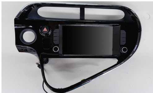
07. 내비마감재에 순정 몰딩과 비상등을 결합 합니다. 내비브라켓을 이용해 내비게이션도 장착해 줍니다.
