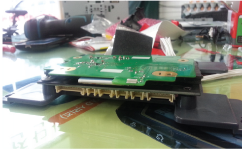
04. 트립브라켓에 트립, LCD-PCB를 그림과 같이 쌓아줍니다.
