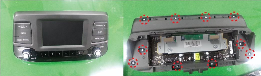
01. 오디오 앞판 마감재를 그림과 같이 분리합니다. 02. 뒷면의 표시된 나사를 풀어 뒷판 커버를 분리합니다.
